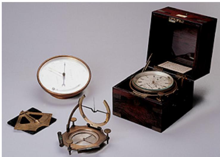
左から、象限儀、気圧計、方位測定儀、クロノメーター
