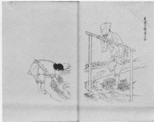
⑤ 川水に浸した黒皮を取り出し、足で踏み揉んで荒皮を落とす。
