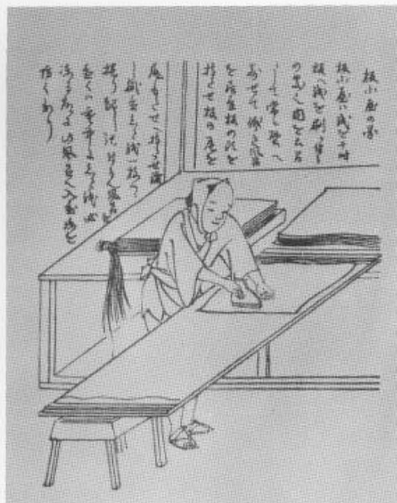
⑳ 絞った漉紙を一枚ずつはがし、板の表裏に刷毛で質肌の方を張付ける。
