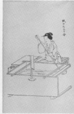
⑰ 漉舟の中へ水と、⑪の楮皮、⑬の米糊、さらに⑭のねりを加え、タテギと呼ばれる棒でよく攪拌する。これを「紙をたてる」という。
